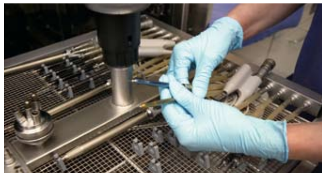
Instrumente mit Hohlkörpern werden sorgfältig angeschlossen.
